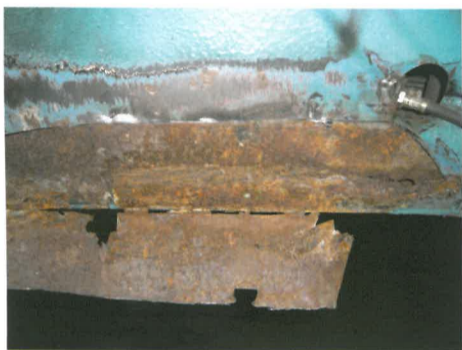
Längsträger 1. Schicht im Radkasten
